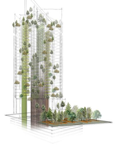
「URBAN FOREST」という設計コンセプトを掲げ、都市の中の新しい環境空間を目指し、2021年度の竣工に向けて建設中。インテリアにも「URBAN FOREST」を感じさせるデザインをちりばめながら、建築の内外が連続した一体的な空間となるよう設計している。特徴的なV型コラムには、当社の高層タワー等の鉄骨制作のノウハウを結集させている。BTS NANA 駅と直結した敷地前面のオープンスペースには、同じV型をモチーフにしたランドスケープが展開している。
